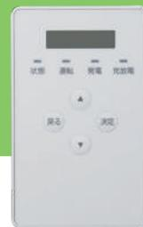
蓄電システムをグリーンモードに変更したい場合は、蓄電システム用ゲートウェイを操作します。
